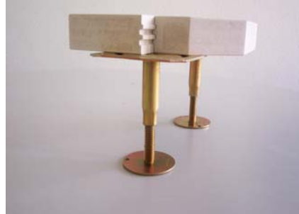
Faserverstärkte Kalziumsulfatplatte A2, 600 x 600 mm, mit spezieller Kantenverzahnung und höhenverstellbarer verzinkter Stahlstütze M 16 / M20 abhängig von der Aufbauhöhe
