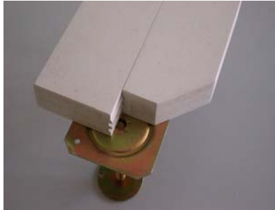
Faserverstärkte Kalziumsulfatplatte A2, 600 x 600 mm, mit spezieller Kantenverzahnung und höhenverstellbarer verzinkter Stahlstütze M 16 / M20 abhängig von der Aufbauhöhe
